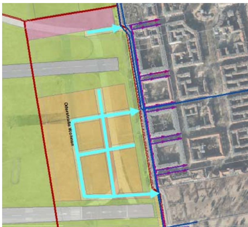
Abbildung 57: Anschluss an die öffentliche TW-Versorgung im Wohngebiet Oderstraße
